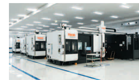
Sankyo Dream Factory引进的INTEGREX i系列的FMS生产线
